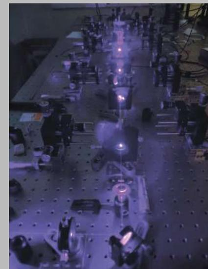
Источник 6-фотонных состояний на основе спонтанного параметрического рассеяния света
