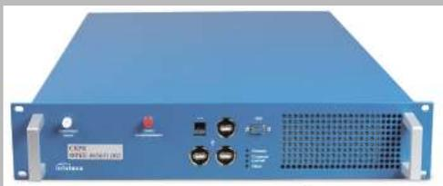
Базовый сценарий использования ViPNet Quandor – автоматическая доверенная доставка криптографических ключей для канальных шифраторов ViPNet L2-10G.
