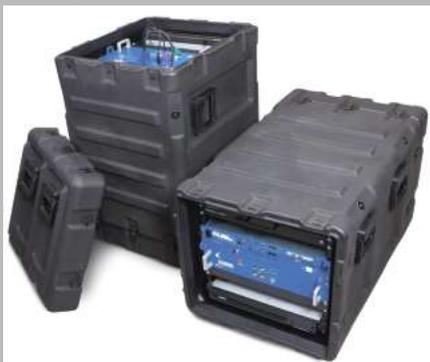
ViPNet Quandor в составе комплекса квантовой криптографической аппаратуры защиты информации собранного в мобильных кофрах для демонстраций и опытных эксплуатаций на сетях заказчика
